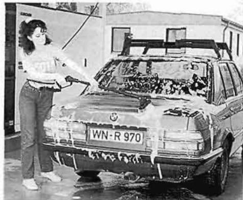
4. Al seleccionar el programa "Lavado con espuma", la instalación conmuta automáticamente a funcionamiento con baja presión; con ayuda de un compresor se genera una espuma particularmente consistente, cuyas características pueden variarse según las necesidades o deseos concretos.
