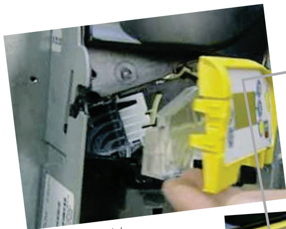
El nuevo diseño del separador del Cashflow 7900 permite la resolución rápida de los atascos
